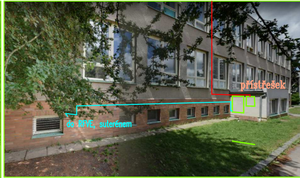
Foto: místo pro umístění 3fáz. invertoru a rozváděče RFVE–DC (návrh)
